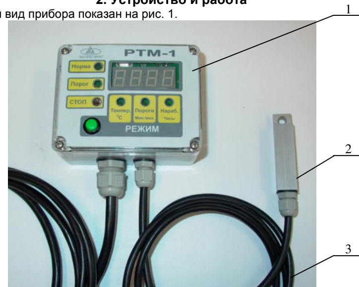
1 – блок индикации; 2 – датчик температуры; 3 – кабель. Рис. 1.
